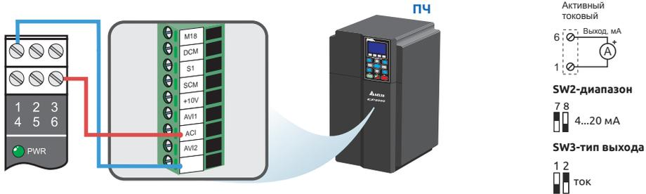
Схема подключения пассивного токового выхода 4...20 мА (с внешним блоком питания)
