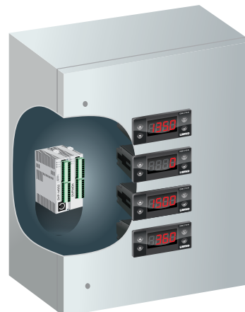
Задание пользовательских значений/уставок/коэффициентов в ПЛК через аналоговые входы без использования НМИ
