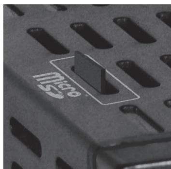
ECD4-L имеет встроенную функцию архивирования измеренных величин, температуры окружающего воздуха и состояние дискретных входов при их наличии. Для этого в верхней части корпуса прибора имеется слот для установки карты памяти стандарта microSD объемом до 32 ГБ, а на лицевой панели - индикатор наличия карты памяти.
