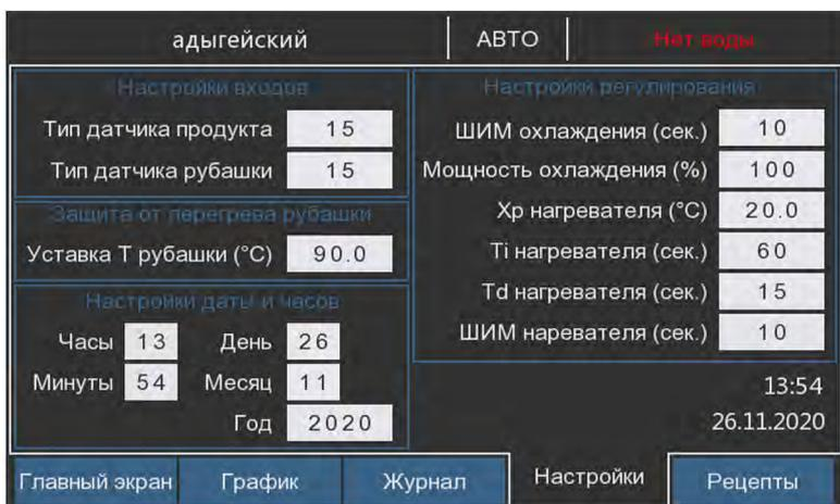
Экран основных настроек позволяет корректировать параметры регулировки, для более точного поддержания температуры продукта. Можно настроить защиту от перегрева рубашки, тип подключаемых датчиков температуры и текущее время.
