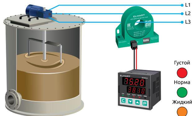
Косвенное определение вязкости сред по току потребления мешалок. Определение наличия среды в зоне мешалки. Определение режимов работы двигателя (перегрузка / рабочий режим / холостой ход).
