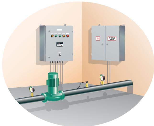
Использование шкафа управления КАСКАД 10 в системе с одним насосом
