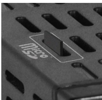
ECD8 имеет встроенную функцию архивирования измеренных величин и температуры окружающего воздуха. Для этого в верхней части корпуса прибора имеется слот для установки карты памяти стандарта microSD объемом до 32 Гб, а на лицевой панели - индикатор наличия карты памяти.
