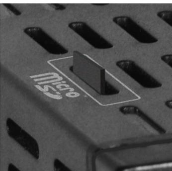
ECD4 имеет встроенную функцию архивирования измеренных величин, температуры окружающего воздуха и состояния дискретных входов при их наличии. Для этого в верхней части корпуса прибора имеется слот для установки карты памяти стандарта microSD объемом до 32 Гб, а на лицевой панели - индикатор наличия карты памяти.
