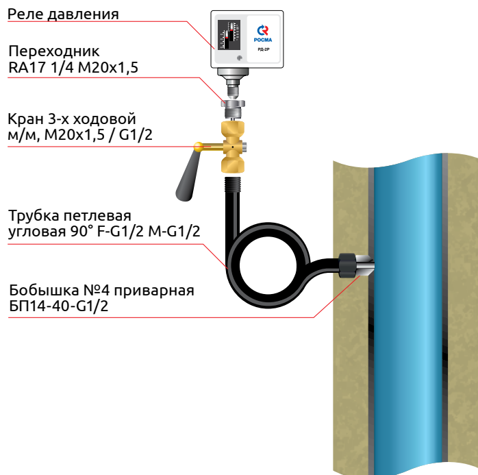
Установка на вертикальном участке трубопровода
