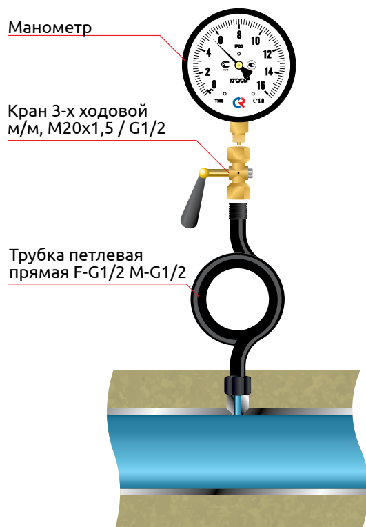
Установка на горизонтальном участке трубопровода
