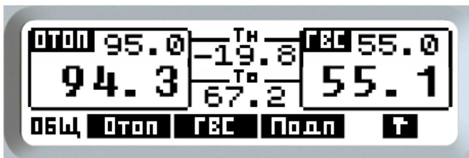
Рисунок 2.17— Индикация ручного режима
