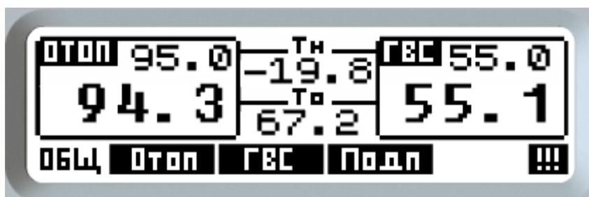
Рисунок 2.14 — Индикация аварийной ситуации
