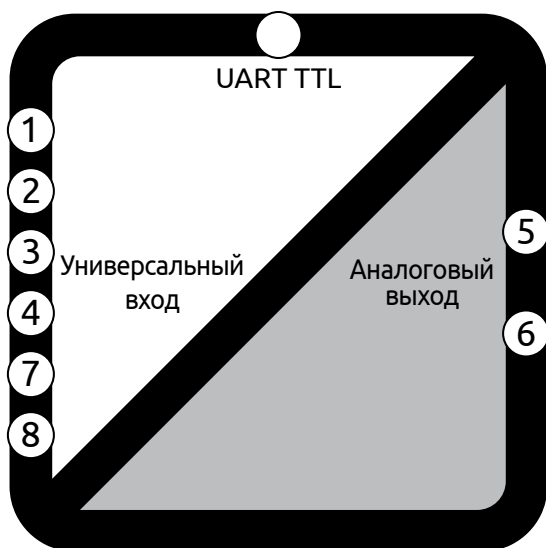
Рисунок 1 - Линии гальванической развязки цепей преобразователя
