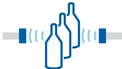
Рисунок 3 – Пример работы датчиков серии ews в качестве ультразвукового барьера.
