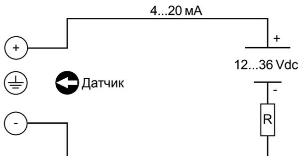
Рисунок 4 — Схема подключения датчика
