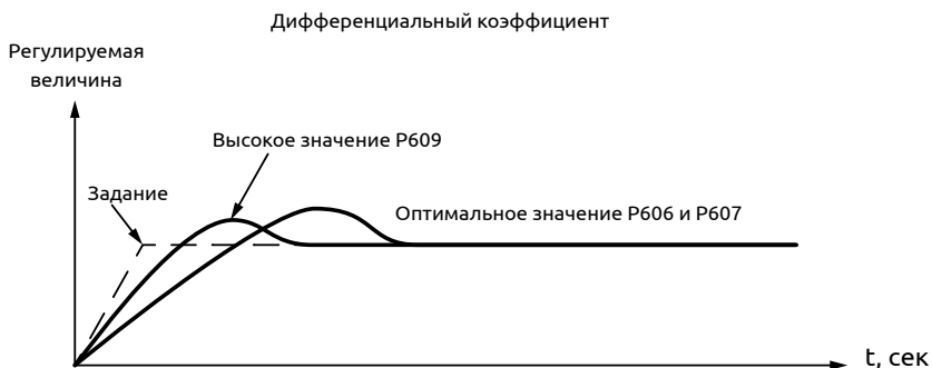
Рисунок 64 – Влияние коэффициентов регулятора на переходный процесс
