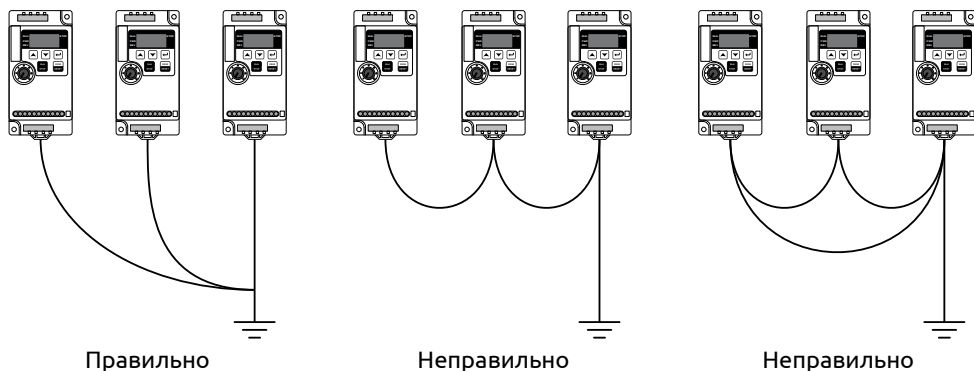
Рисунок 7 – Схема подключения заземления
