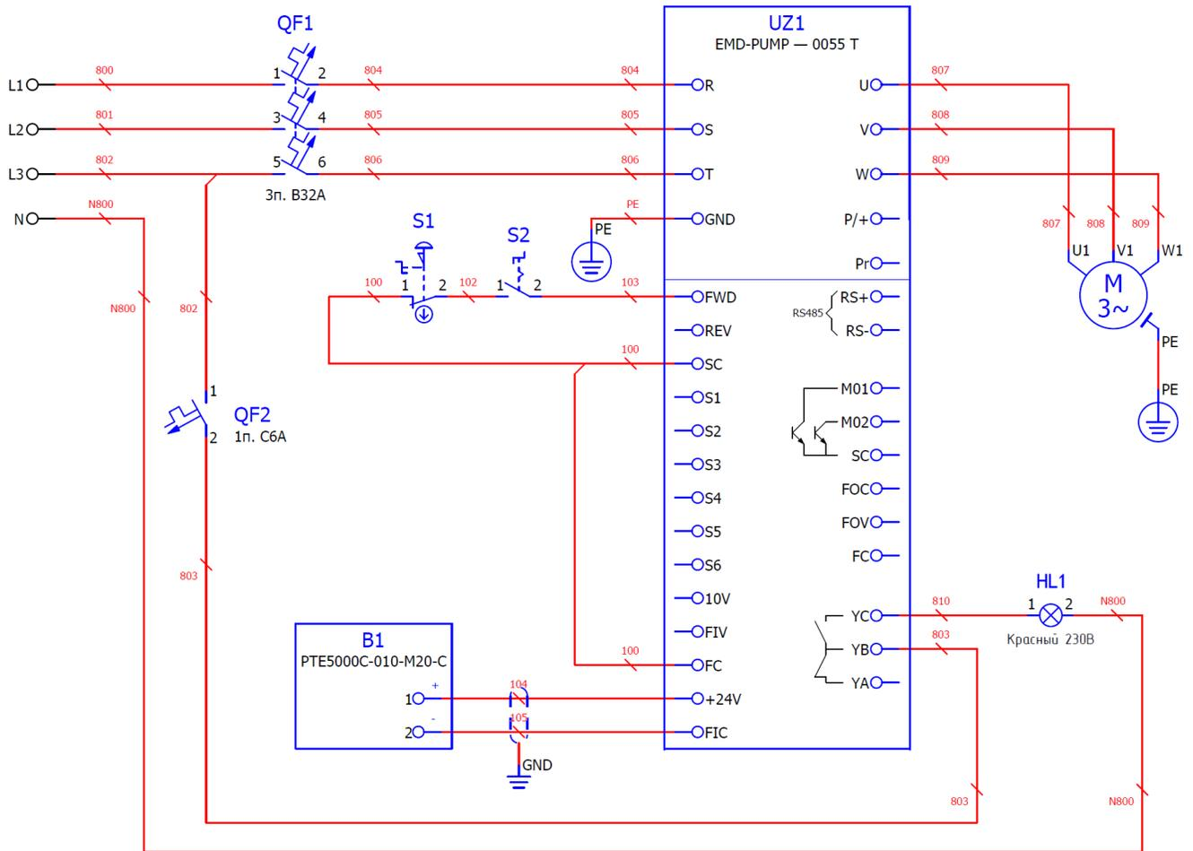
Рисунок 1 — Подключение ПЧ ELHART серии EMD-PUMP
