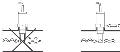
При монтаже датчика в трубе вилка должна быть расположена параллельно потоку.
